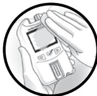
**IMPORTANTE:** tenere l'area bagnata di disinfettante per due minuti. **NON** lasciare a bagno, saturare o immergere l'analizzatore o lasciare che il liquido si raccolga sulle superfici. Accertarsi sempre che l'analizzatore sia asciutto prima dell'uso.
